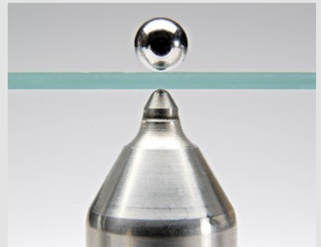
Referenční kuličky se speciální povrchovou úpravou a rozměrovou přesností pro získání maximální opakovatelnosti měření.
