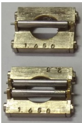
drátky v kleci pro měření středního průměru závitu
