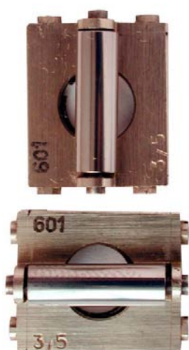
drátky v kleci pro měření ozubení
