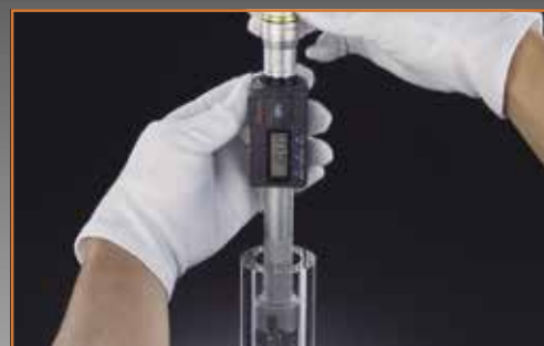
Typický způsob použití dutinoměru Holtest
