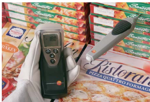
Kontrola při přejímce zboží - díky rádiové sondě nepřekáží žádný kabel
