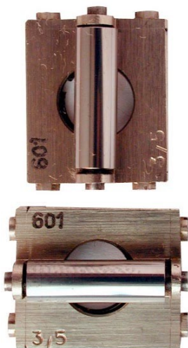
drátky v kleci pro měření ozubení
