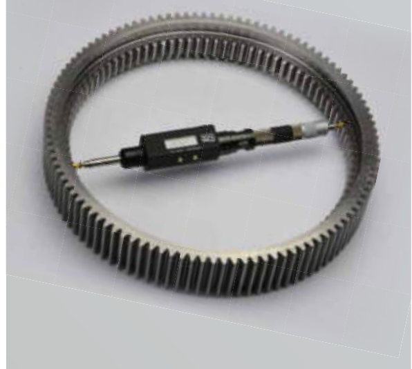
Abb. 2 – Messung des diametralen Zweikugelmaßes bei Innenverzahnung
