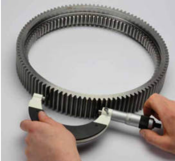
Abb. 1 – Zahnweitenmessung bei Außenverzahnung
