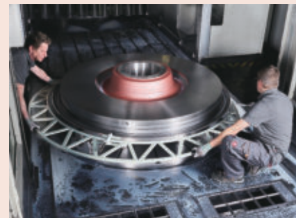
Příklad použití s nastavitelným dorazem na obrobku
