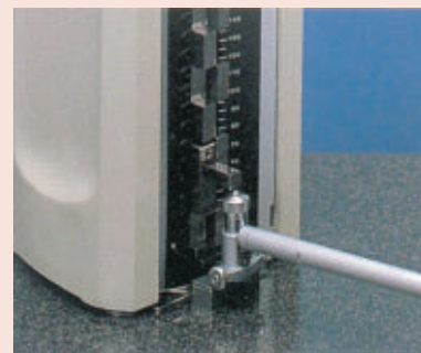
Příklad referenčního nastavení dutinoměru
