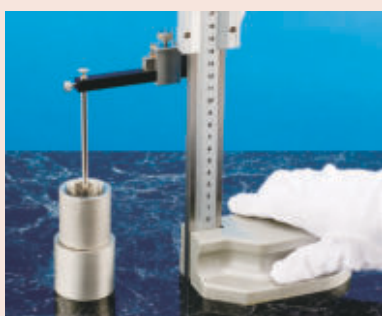
Přípevnění hloubkoměrného doteku
