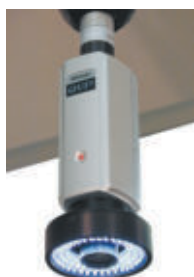
QVP (Quick Vision Probe - Kamerová snímací sonda)
