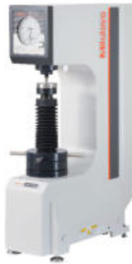
HR-210MR Tvrdoměr Rockwell
