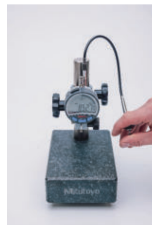
Aplikace s použitím zdvihacího tl. vřetene
