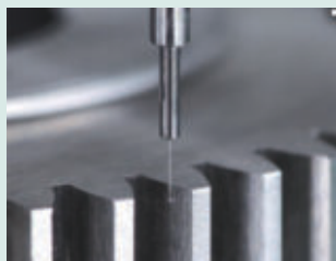
Měření ozubení pomocí MPP-Nano Modul 0,8
