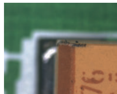
Normální pozorování mikroskopem (vyšší) Při rozdílu výšek lze zaostřit pouze na horní nebo dolní rovinu.
