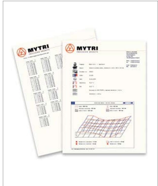
Prüfzertifikat Granit-Meßplatte mit Rückführbarkeit auf (inter-) nationale Normale.
